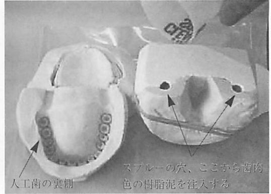
図10 ろうが流れて歯肉部分が空洞になった鑄型
